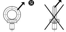
Per un corretto uso del golfare rispettare i limiti di utilizzo indicati in tabella. Per un agevole montaggio del golfare assicurarsi che le parti filettate, vite e madrevite, siano adeguatamente pulite; verificare inoltre l'idoneità della classe di resistenza della madrevite il cui materiale deve avere una classe di resistenza a trazione ≥ a quella dell'acciaio S235JR (norma di riferimento EN 10025).
