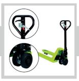
Frein à contrôle manuel. Le frein du transpalette, disponible avec des roues directrices caoutchouc et nylon/poly, est réglable par le biais du timon pour garantir une utilisation en toute sécurité sur les pentes et les rampes. La fonction de verrouillage permet de stationner le transpalette même sur des pentes.
