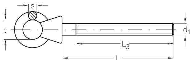
Piton à œil fileté INOX modèle long, filetage à droite
