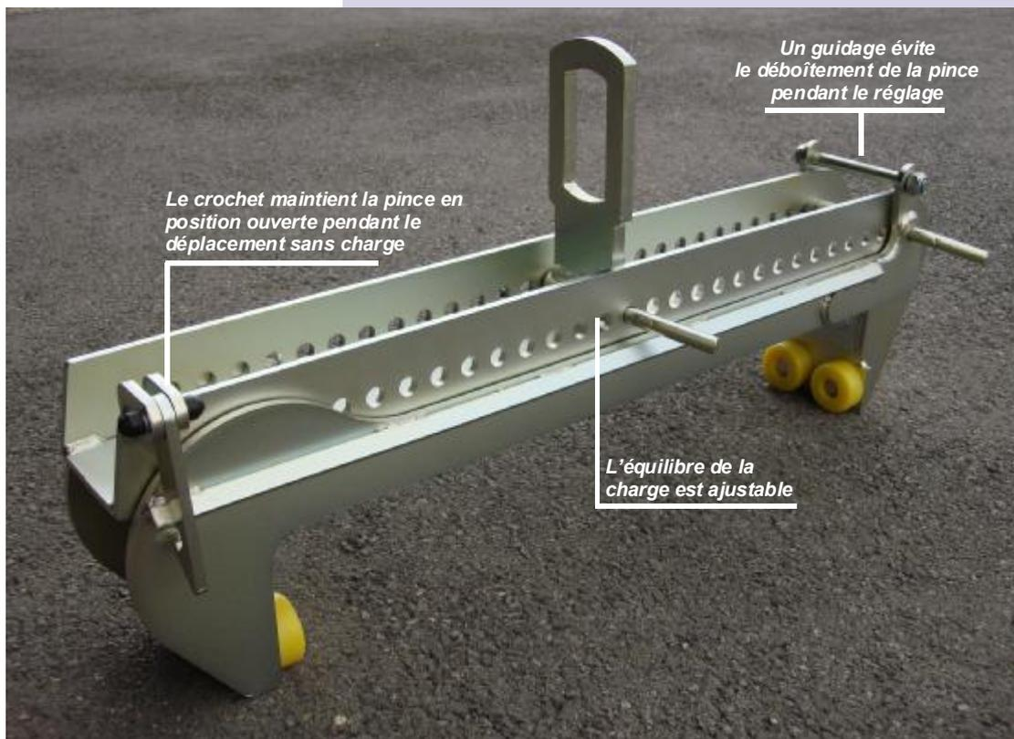
Le crochet maintient la pince en position ouverte pendant le déplacement sans charge
