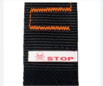
Témoin de chute activé
