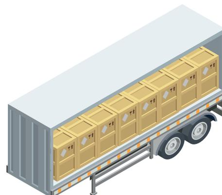
Pour utiliser cette technique d'arrimage, le véhicule utilisé doit être certifié selon la norme EN 12642 L ou EN 12642 XL afin d'attester que ses parois sont renforcées et assez solides pour supporter ce type d'arrimage.
