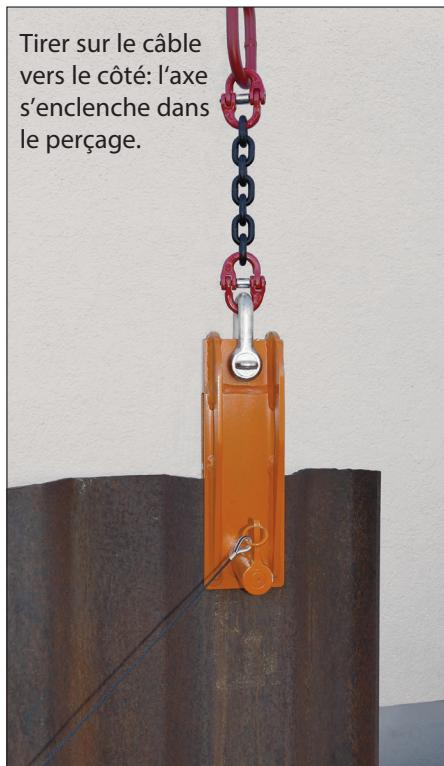
Tirer sur le câble vers le côté: l'axe s'enclenche dans le perçage.
