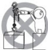
ne JAMAIS lever une charge supérieure à la cote de capacité du palan
