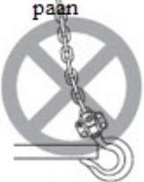
ne JAMAIS supporter une charge sur le bord du crochet
