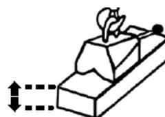
3.3 Placez l'aimant de levage **DELTA** sur la surface du matériau et veillez à ce que la ligne médiane convienne. La surface totale de la partie magnétique doit entrer en contact avec le matériau en acier à hisser. Ensuite, tournez la manette de off à on jusqu'à ce que la clé ait dépassé la goupille de verrouillage. Vérifiez si la clé s'est verrouillée automatiquement avec la goupille. Ensuite seulement on peut commencer à hisser (la charge doit rester en équilibre).
