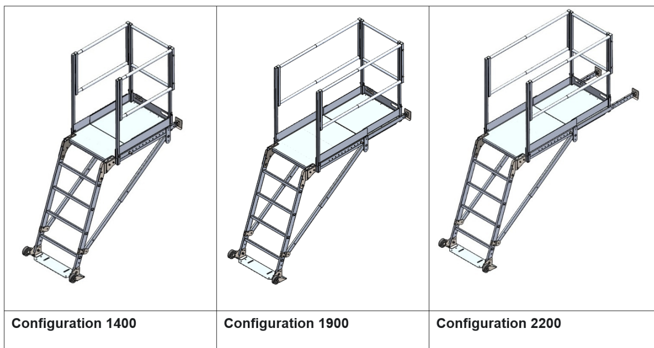
Figure 5: Vues des trois configurations télescopiques de la plate-forme EPAP (1400, 1900 et 2200 mm), illustrant les longueurs de déploiement possibles selon la profondeur de la fosse d'ascenseur.
